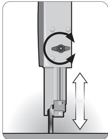
**Ajuster la hauteur de coupe de façon en fonction de la pièce à usiner.**
