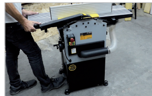
Système pour déplacer facilement la machine System to easily move the machine
